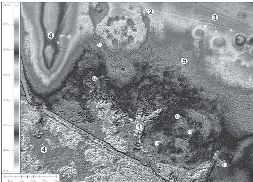
Рис. 2. Комплекс объектов Сибаркуль. Цифровая модель поверхности с затенением холмов HSV-шейдером (отображает высоты значением насыщенности оттенка). Значение вертикального преувеличения равно 10 единицам
